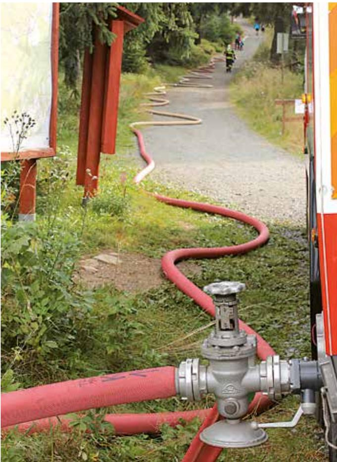
Löschwasserversorgung vom Tanklöschfahrzeug zum Brandherd
